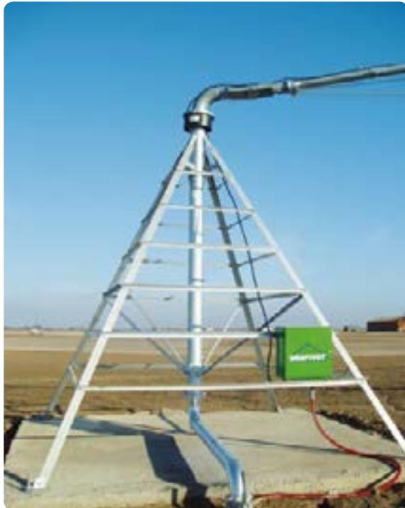
El anillo colector **Urapivot** situado en la parte superior de la estructura sobre la que gira el pivote (Centro Pívot); permite que toda la energía eléctrica se mantenga fuera del tubo de subida del agua, tomando los 380 V de fuerza del panel principal y distribuyéndola del centro de mando a cada torre. Las claves de su fiabilidad son su montaje externo y una robusta cubierta de poliéster prensado resistente a la corrosión que protege el anillo de la humedad.
